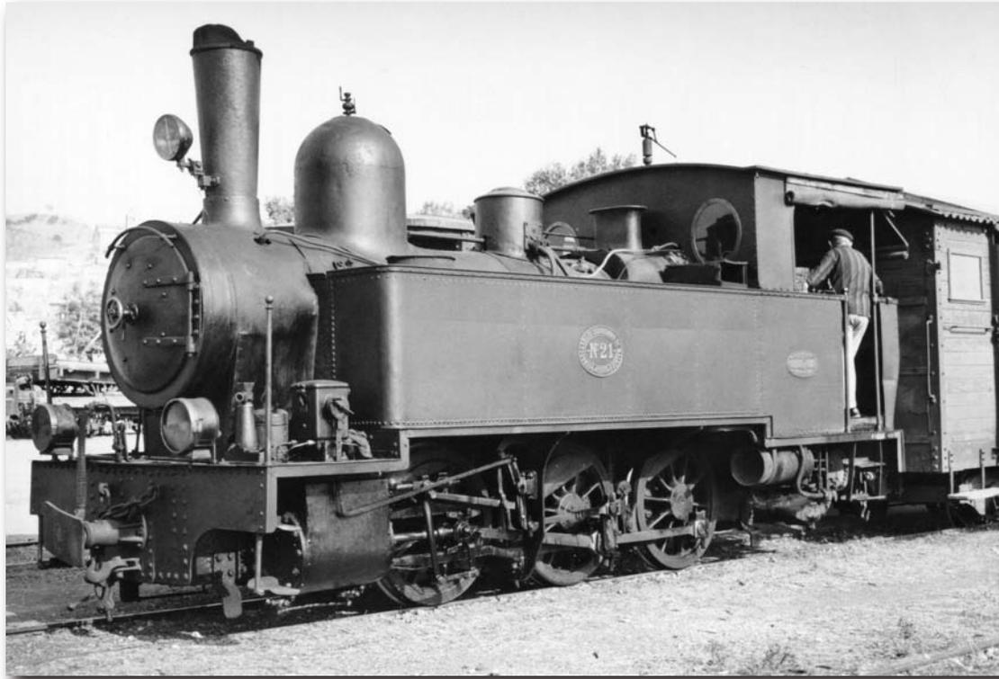
Las locomotoras de estos trenes funcionaban con la fuerza producida por el vapor de agua, un mecanismo basado en la maquina de vapor inventada por James Watt en 1769. Viajaba a una velocidad media de unos 20 km/h y podía arrastrar hasta varios cientos de toneladas.
